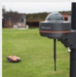
Die Referenz-Station verbessert die Navigation des Mähers
