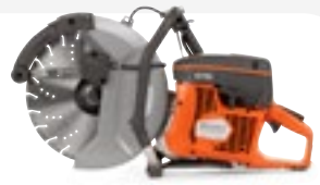
BENZIN-ANTRIEB HUSQVARNA K 770 SMARTGUARD 74 cm 3 , 3,7 kW, 10,8/11,1 kg, Scheibendurchmesser 300/350 mm, Schnitttiefe 100/125 mm.
