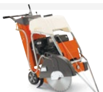
DIESEL-/BENZIN-ANTRIEB REIHE HUSQVARNA FS 400 Diamanttrennscheibe max. 500 mm, Schnitttiefe 189 mm, 163 kg. FS 413, Benzin, 8,7 kW*. FS 410 D, Diesel, 6,6 kW*.
