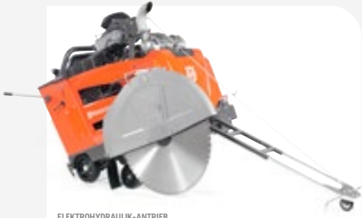
ELEKTROHYDRAULIK-ANTRIEB HUSQVARNA FS 7000 D Diamanttrennscheibe max. 1.000 mm, 1032 kg, Schnitttiefe 411 mm, 55,4 kW*.
