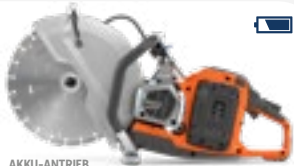
AKKU-ANTRIEB HUSQVARNA K1 PACE 7,2/7,4 kg, Scheibendurchmesser 300/350 mm, Schnitttiefe 121/145 mm, PACE 94V-Akku-System.
