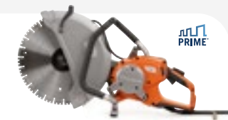
ELEKTRO-ANTRIEB HUSQVARNA K 7000 230/400 V, 5,5 kW (dreiphasig) / 3 kW (einphasig), 9,1 kg, Scheibendurchmesser 400 mm, Schnitttiefe 155 mm.
