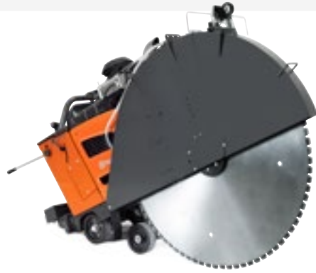
ELEKTROHYDRAULIK-ANTRIEB HUSQVARNA FS 7000 DL Diamanttrennscheibe max. 1.500 mm, 1338 kg, Schnitttiefe 625 mm, 55,4 kW*.
