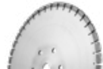
REIHE G HUSQVARNA HEGER FCF20 FAF30 Fugenschneidblätter zur Herstellung von „Trockenschnitt Fugen“. Erhältlich in zwei Ausführungen mit 8 oder 10 mm Segmentbreite. Durchmesser 350 – 450 mm.
