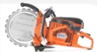
BENZIN-ANTRIEB HUSQVARNA K970 RING 94 cm 3 , 4,8 kW, 13,8 kg, Scheibendurchmesser 370 mm, Schnitttiefe 270 mm.
