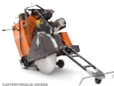
ELEKTROHYDRAULIK-ANTRIEB HUSQVARNA FS 3500 EFI G Diamanttrennscheibe max. 750 mm, 419 kg, Schnitttiefe 311 mm, 27,5 kW*.
