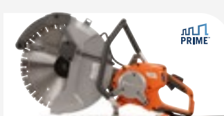
ELEKTRO-ANTRIEB HUSQVARNA K 7000 SMARTGUARD 230/400 V, 5,8 kW (dreiphasig) / 3 kW (einphasig), 5,1 kg, Scheibendurchmesser 400 mm, Schnitttiefe 145 mm.
