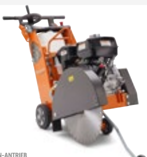
BENZIN-ANTRIEB HUSQVARNA FS 400 LV Diamanttrennscheibe max. 450/500 mm, Schnitttiefe 162/189 mm, 99 kg, 8,7 kW*.
