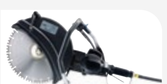
DRUCKLUFT-ANTRIEB HUSQVARNA K 400 7 kp/cm 2 , 3,2 kW, 9,9 kg, Scheibendurchmesser 350 mm, Schnitttiefe 125 mm.
