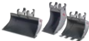
HUSQVARNA-LADESCHAUFELN In drei Größen erhältlich. Für DXR 140/145: Standard 52 cm/55 Liter. Breit 77 cm/60 Liter. Schmal 30 cm/40 Liter. Für alle anderen DXR: Standard 52 cm/85 Liter. Breit 77 cm/105 Liter. Schmal 30 cm/40 Liter.
